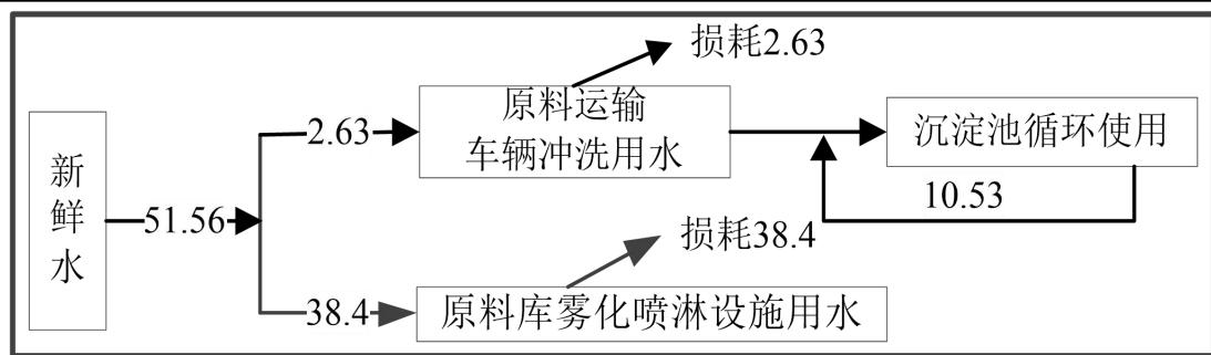
图1 本项目改扩建工程水平衡图 (单位:  $\text{m}^3/\text{d}$ )
